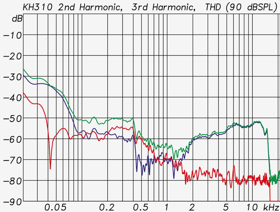
Harmonic Distortion at 95 dB SPL | Klirrfaktor bei 95 dB SPL
